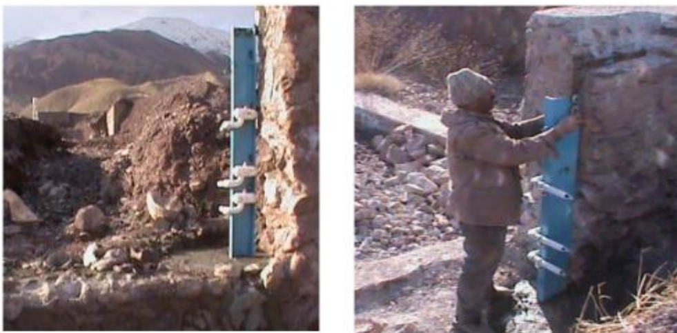
شکل ۴ - جاگذاری نمونه بردارها در مسیر رودخانه انگشتجان (راست) و امستجان (چپ)
