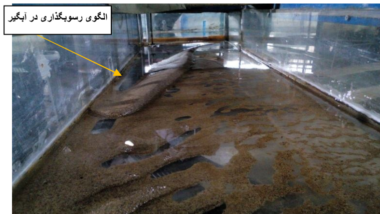
شکل ۱۱- تغییرات توپوگرافی دهانه آبگیر و رسوبات ورودی به آبگیر در حالت وجود سازه دیوار جداکننده و آبشکن
