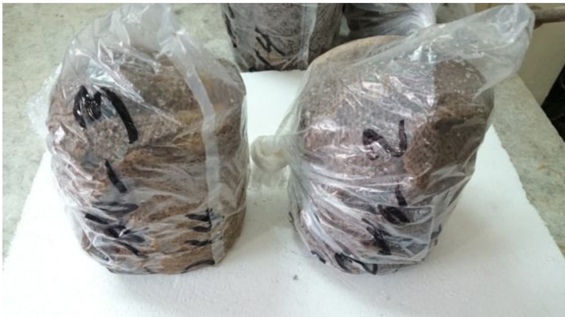
شکل ۳- نمایی از تامین شرایط اشباع از رطوبت برای عمل آوری نمونه های خاک-سیمان
