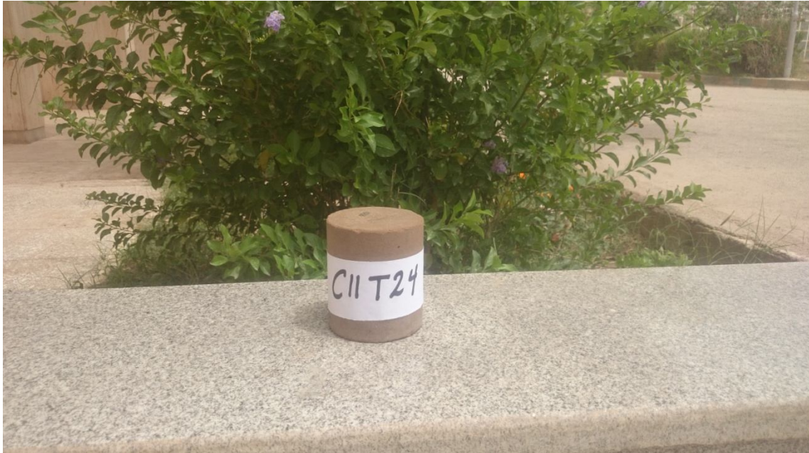
شکل ۲- نمایی از نمونه ساخته شده با مصالح خاک-سیمان
