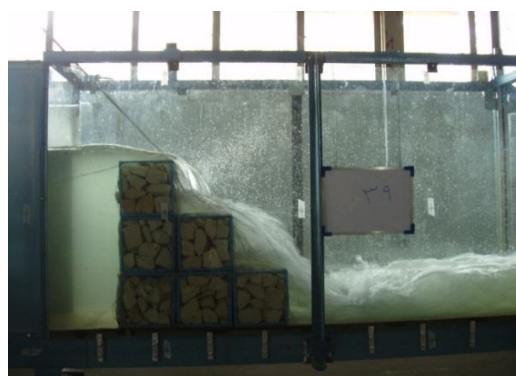
شکل ۱۰- نمونه آزمایش برروی مدل سرریز پلکانی گابیونی- رجائی و همکاران (۱۳۹۶-الف)
