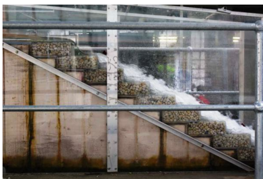
شکل ۱۴- مدل سرریز پلکانی با یک ردیف جعبه گابیون (وودریج و چانسون، ۲۰۱۴)
