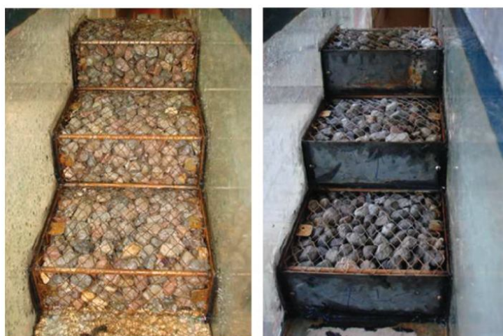
شکل ۹- مدل آزمایش‌های مربوط سلماسی و همکاران (۱۳۹۰) - سمت چپ (G) و سمت راست (GH)
