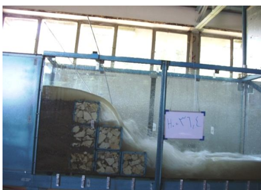
شکل ۱۱: نمونه آزمایش برروی مدل سرریز پلکانی گابیونی با رسوب- رجائی و همکاران (۱۳۹۶-ب)
