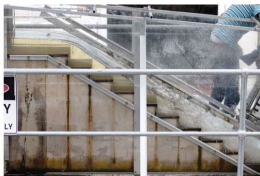
شکل ۱۳- مدل سرریز پلکانی صلب (غیر گابیونی) (وودریج و چانسون، ۲۰۱۴)
